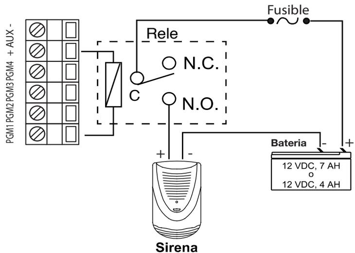
**NOTA:** Las salidas PGM no pueden ser inhabilitadas completamente en la programación del instalador. Para inhabilitar completamente una salida PGM, debe remover todo el cableado de la misma.
