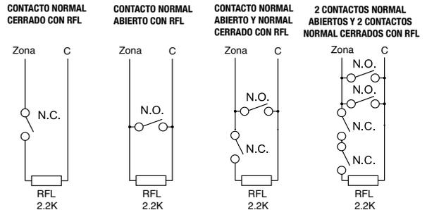
**NOTA:** Este es el modo adecuado de conexión para contactos de detección Normalmente Abiertos (N.O.) o Normalmente Cerrados (N.C.).
